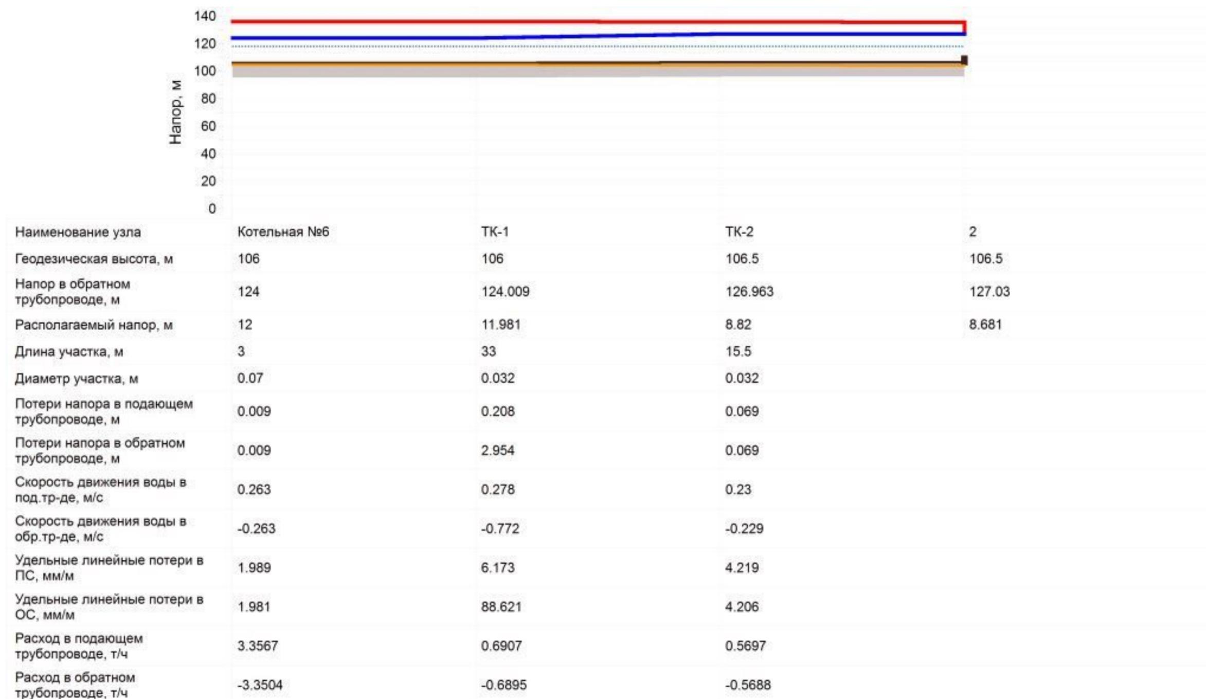
Рис. ПЗ.8 Пьезометрический график тепловой сети Котельной №6 (с учетом проведенных мероприятий).
